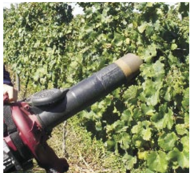
Figura 5 - Equipo de succión utilizado para capturar artrópodos aéreos.
