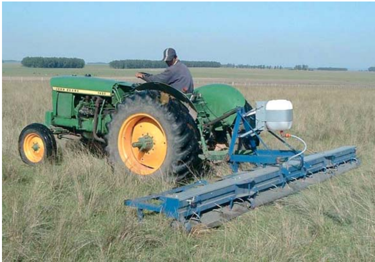
Figura 10. Máquina de alfombra con dosificación electrónica.
