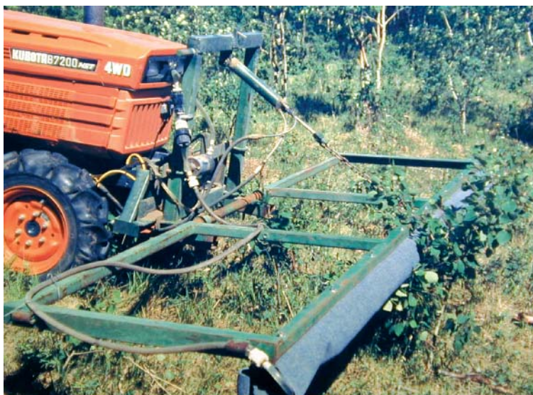
Figura 1. Control de rebrotes de álamos en Canadá con máquina de alfombra.
