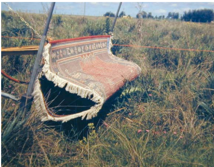
Figura 8. Máquina de alfombra con pastillas de pulverización, INIA La Estanzuela.
