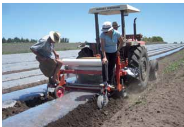
Figura 2 - Colocación mecánica de polietileno para la solarización de los canteros.
