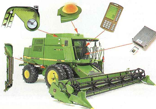
Figura 1 (a): Sistema de posicionamiento global y registro de flujo de rendimiento (b): Cosechadora equipada con sistema cosechando arroz. (Roel, A. et al., 2000).
