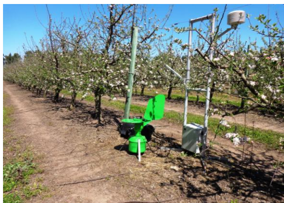
Figura 1.- Trampa caza-esporas Burkard ubicada en monte de manzana ubicado en el departamento de San José.
