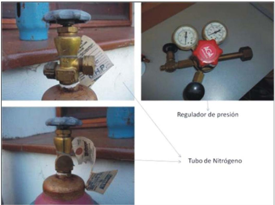
Figura 7. Tubo de gas N<sub>2</sub> alta pureza y Regulador de presión.
