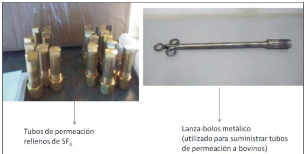
**Figura 4.** Tubos de permeación y lanza bolos metálico.
