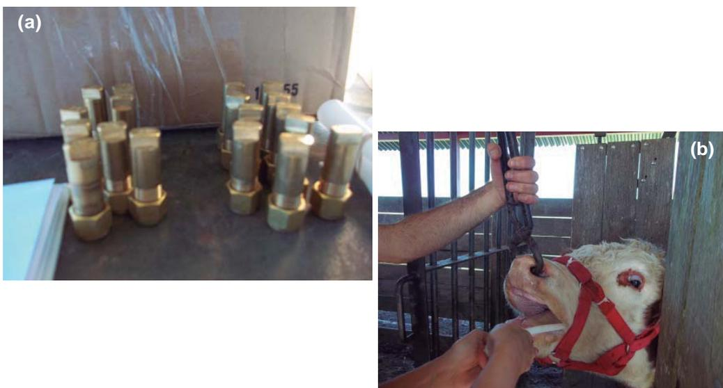
**Figura 9.** (a) Tubos de permeación rellenos de SF<sub>6</sub>; (b) El tubo de permeación es suministrado al animal utilizando lanza-bolo.
