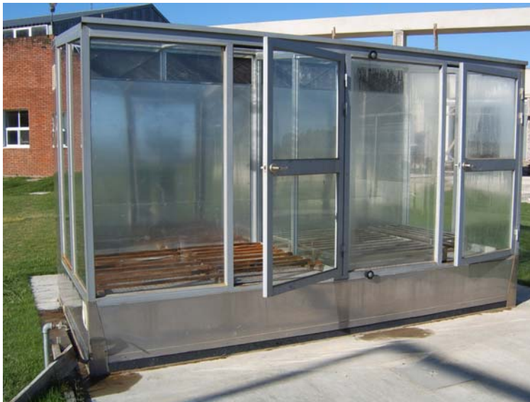
Anexo: cámara de crecimiento con doble compartimento y control independiente de temperatura. Donación de KOICA, Korea.
