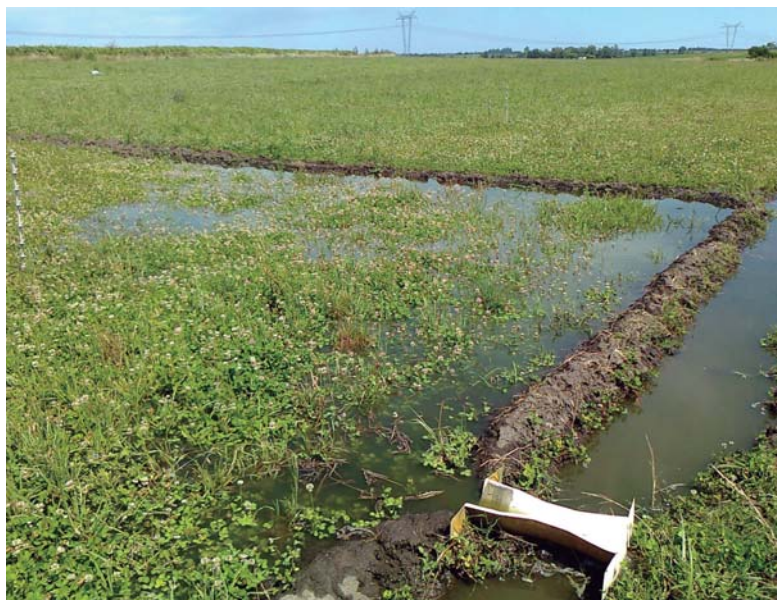
Figura 3. Pie de la melga, con aforador midiendo el caudal escurrido a la salida. Se observa un volumen de agua acumulada sobre el bordo izquierdo de la melga, producto de la falta de nivelación transversal.
