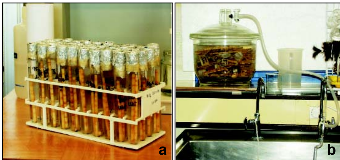
Figura 2. Medición de densidad básica de árboles plus de P. taeda : a) tarugos saturados en agua; b) aplicación de vacío intermitente.
