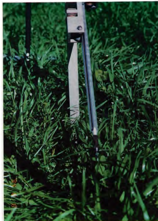
Foto 2 - Evaluación de la estructura vertical de la pastura con el instrumento "Inclined point quadrat" (Punto cuadrado inclinado).
