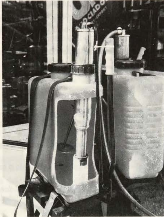
Figura 2. El recorte de una mochila de material plástico muestra el cilindro donde se genera la presión a través de la acción de la palanca manual. Detrás de este cilindro se puede observar el revolveror mecánico que sube y baja con el cilindro y que asegura una aplicación uniforme del caldo.
