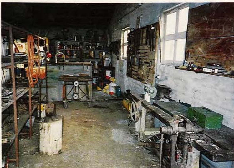
Figura 5. Un taller rural ordenado y equipado con las herramientas básicas, así como un depósito limpio con lubricantes, son una buena base para poder realizar un mantenimiento preventivo adecuado y pequeñas reparaciones de la maquinaria agrícola.
