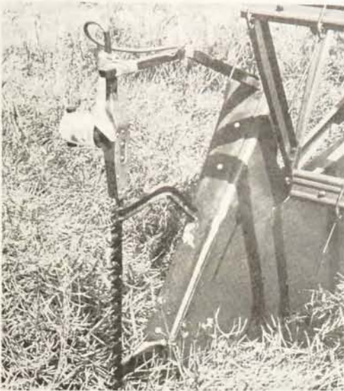
Figura 13. Barra de corte vertical en el lado derecho de la plataforma operada por un motor eléctrico (9). Esto es una solución económica, pero no tan duradera como mandos mecánicos o hidráulicos, cuyo costo inicial es mayor.
