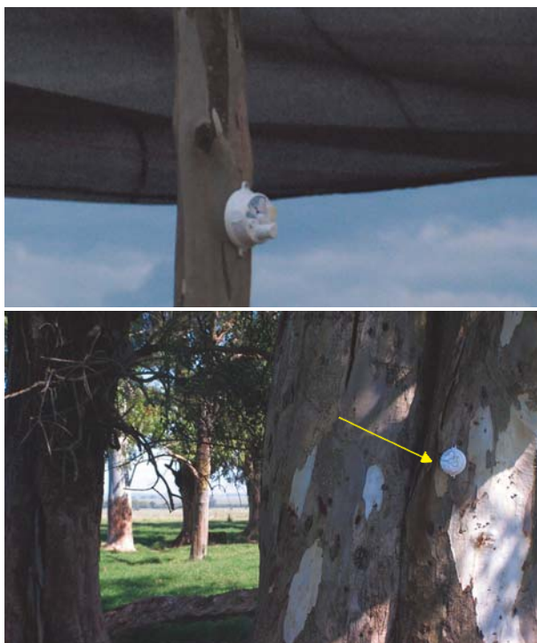
Figura 1. Sensores automáticos de temperatura y humedad del aire colocados en los tratamientos de sombrite y monte natural.
