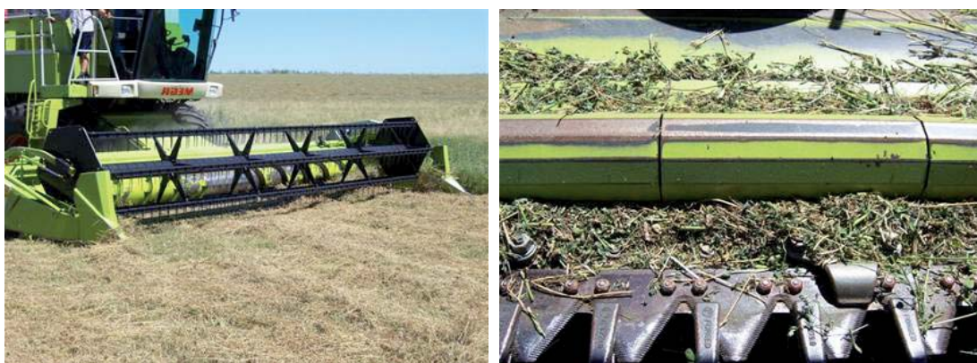
Figura 10. Cosecha de alfalfa Estanzuela Chaná, donde las gavillas se recogen con plataforma Flex.
