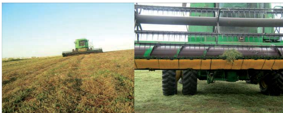
Figura 22. Semillero de lotus cortado e hilerado con pastera de tambores y cosechado con cosechadora provista de plataforma flex.
