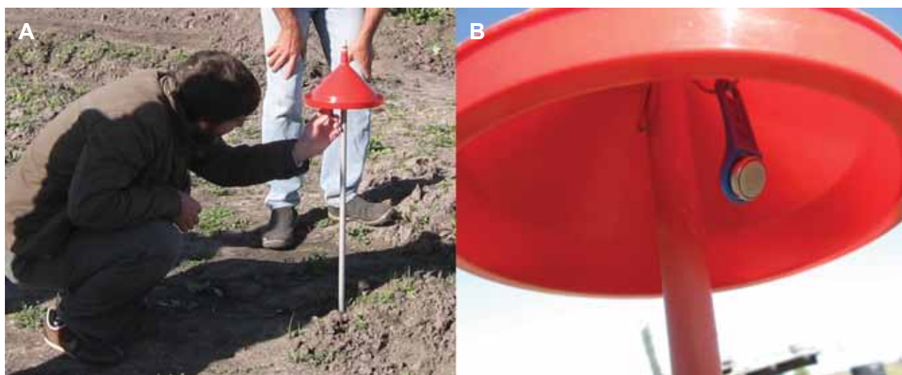
Figura 3 - A. Registradores instalados en campo próximos a cultivos. B. Descarga de datos mediante la interfase.
