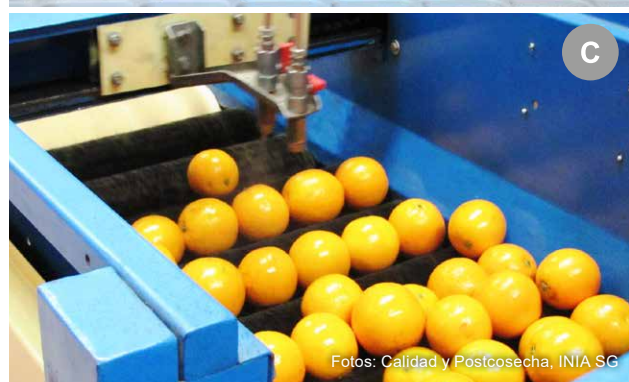
Figura 2 - Aplicación de recubrimientos en minilínea experimental en INIA Salto Grande. Vista general de la minilínea (A), recubrimientos a evaluar (B) y aplicación de recubrimientos en enceradora (C).
