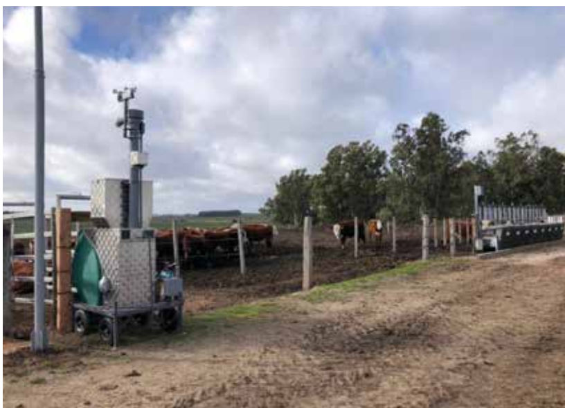
Figura 1. Unidad de medición de metano entérico y comederos para medición automatizada e individual del consumo de alimento.
