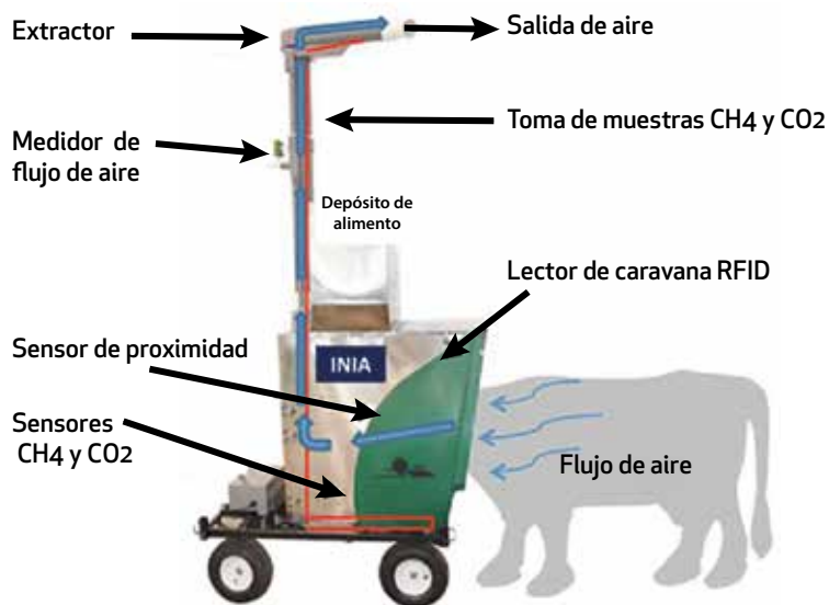
Figura 2. Diagrama de los componentes de los equipos GreenFeed utilizados para la medición de las emisiones de metano (Adaptado de GreenFeed emission monitor system, C-Lock inc. 2014).
