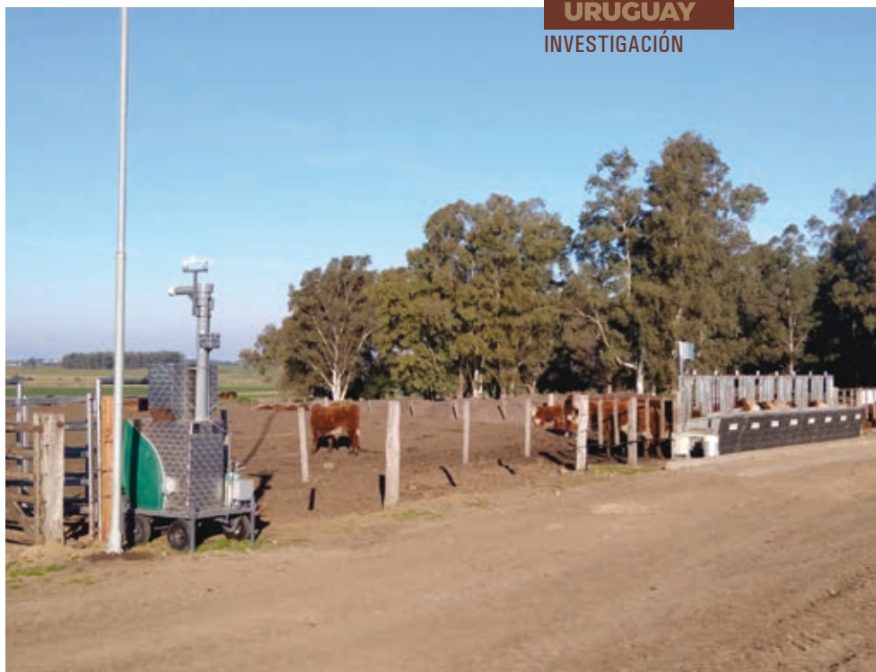
FIGURA 1. Inicio de las mediciones de las mediciones de metano entérico en Hereford. Equipos para la medición de las emisiones de CH 4 entérico diario de toros y novillos Hereford han sido la Central de Prueba de Kiyú junto a los comederos automáticos de registro de consumo de alimento, durante las pruebas de eficiencia de conversión de alimento.
