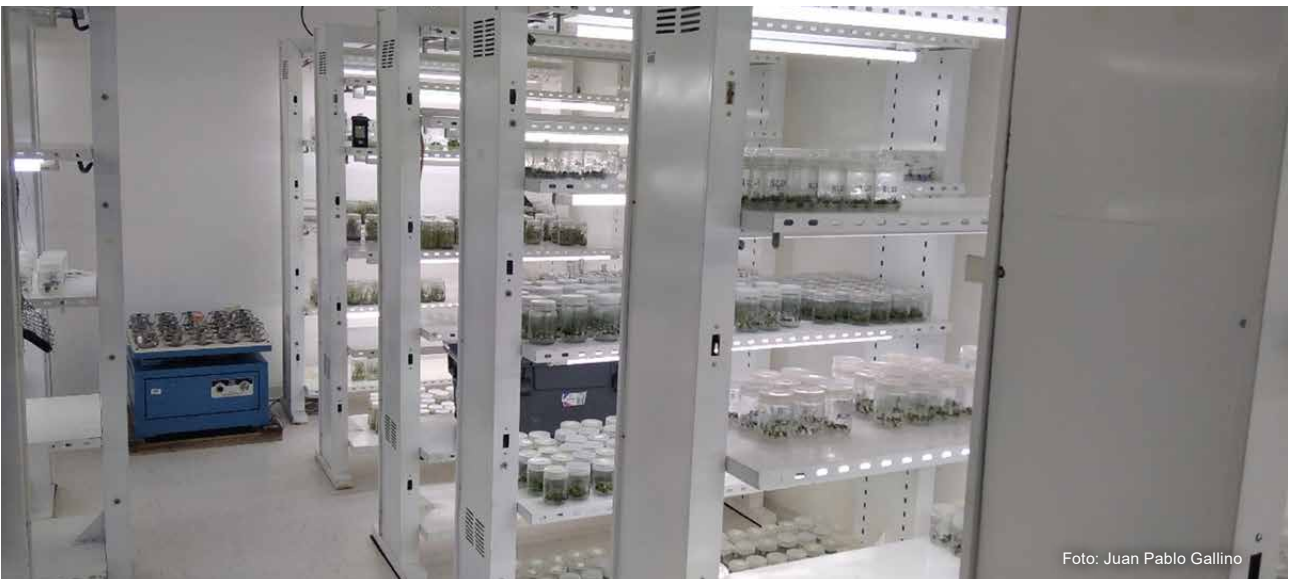
Figura 2 - Cuarto de cultivo in vitro del Laboratorio de Biotecnología de INIA Las Brujas. En el mismo es posible regular la temperatura, intensidad de luz y duración del fotoperiodo.
