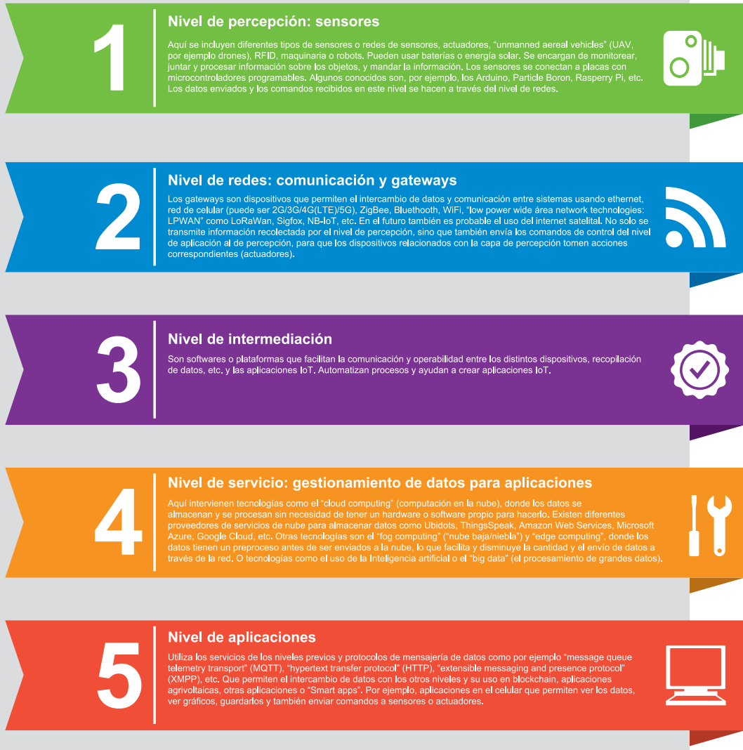
Figura 1 - Diagrama de la arquitectura de un sistema de internet de las cosas (IoT).
