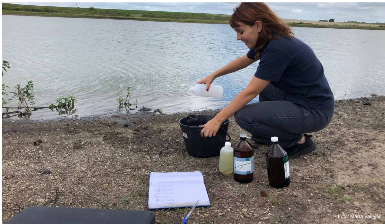
Figura 5 - Toma de muestras para nutrientes, cianobacterias, clorofila y ficocianina en Lago Grande. Las muestras para cianobacterias se fijan con lugol y las muestras para pigmentos se envían en botellas color ámbar para reducir su degradación con la luz. Ambas se envían refrigeradas al LATU para ser procesadas dentro de las siguientes 24 horas.
