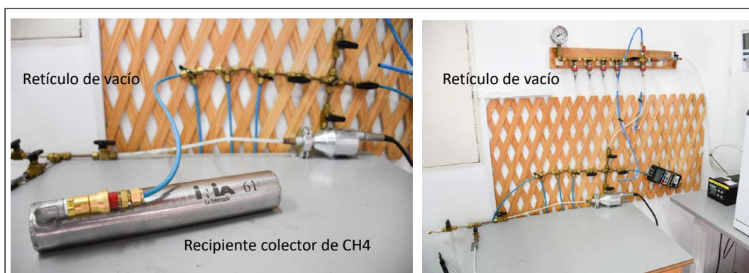
Figura 16. Tubos colectores de metano conectados al retículo de vacío para ser evacuados y limpiados con N 2 .
