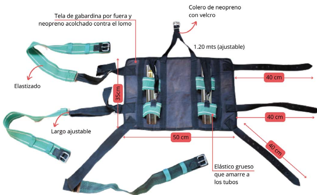
Figura 6. “Mochila” para colocación de tubos colectores en lomo del animal. Diseño INIA.
