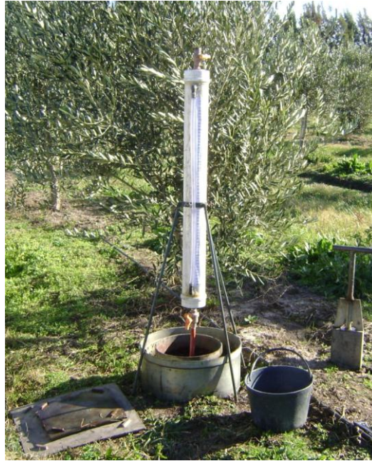
Figura 2. Duplos anéis concêntricos e do cano de PVC utilizados para a determinação da infiltração de água no solo.
