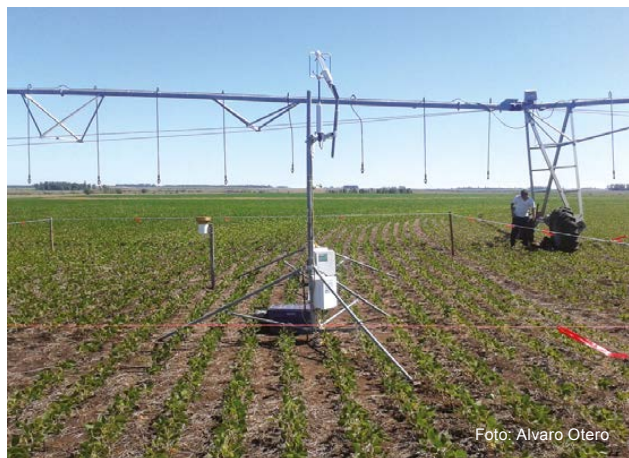
Figura 4 - Torre Eddy covariance colocada en sistema de producción de soja bajo riego.
