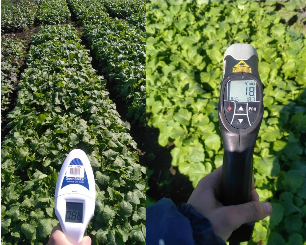
**Fotografías N°4 y 5.** Mediciones de NDVI y temperatura de canopia (°C), respectivamente; realizados el 04-Ago- 2017.
