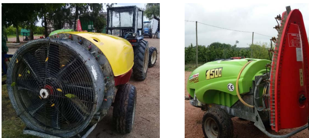
Figura 6: pulverizadoras axial y de torre utilizadas, con picos antideriva.
